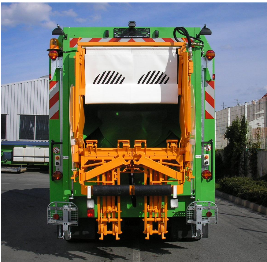
Obrázek 5 Ilustrační fotografie vyklápěče ZOELLER – typ 321
