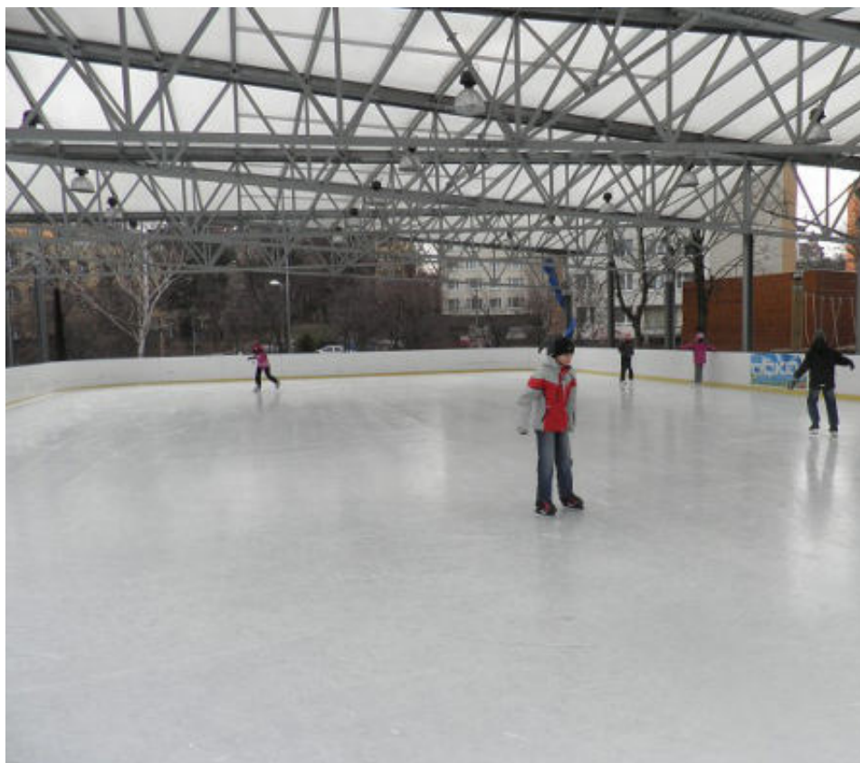
obr. 02. Ledová plocha v zimě se využívá pro hokej a veřejné bruslení, chladící technologie je zabudována do betonové plochy pod ledem, zdroj: verejne-brusleni.info.cz, 2024
